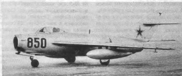
МиГ-17 серийный с подвижными баками
